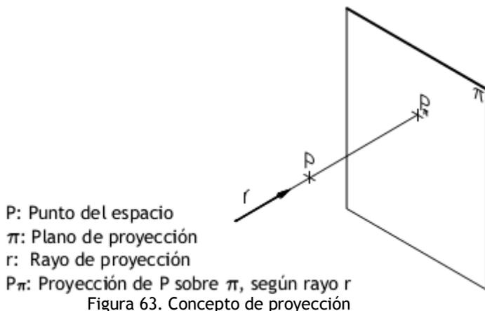
Llamaremos proyección de una figura a la figura resultante de proyectar los puntos de la figura dada sobre un plano. Según la dirección que lleven los rayos proyectantes con respecto al plano de proyección se tendrán diferentes sistemas.
