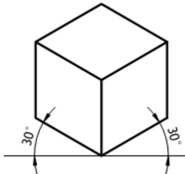
Figura 117. Isometría de un cubo
