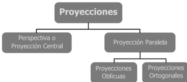
Figura 64. Esquema de los diferentes sistemas de proyección
