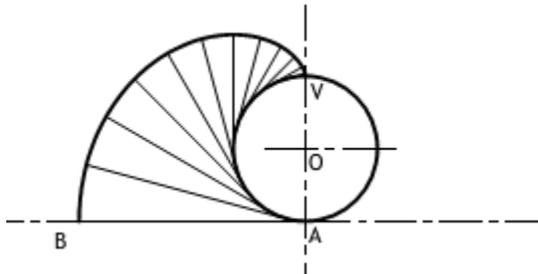
Figura 45. Evolvente de círculo por extremo de la soga
