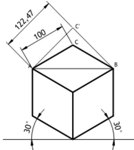
Figura 120. Disposición para calcular coeficientes de reducción
