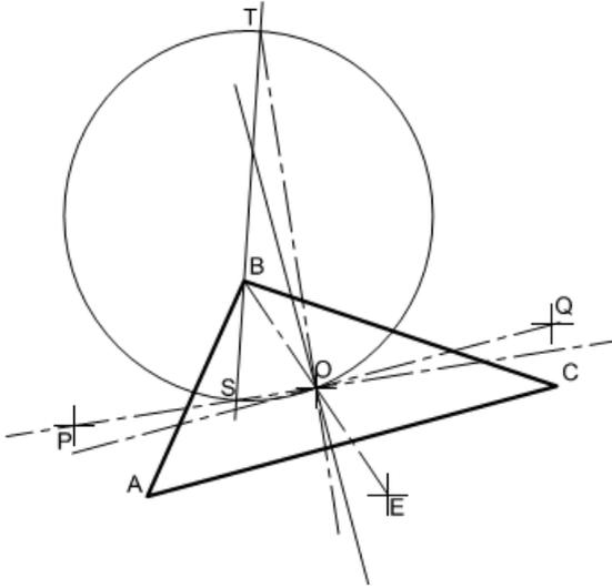
Figura 96. Determinación de ejes principales de la elipse
